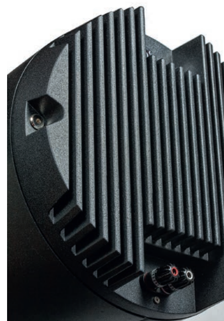
Cylindryczna obudowa głośnika średnionowego jest zamknięta aluminiowym panelem w formie radiatora, który pełni tu rolę bardziej dekoracyjną. Podłączenie głośnika średnionowego wymaga dodatkowego kabla (głośnikowego), prowadzonego z zacisków dolnej sekcji (albo bezpośrednio ze wzmacniacza; sygnał do głośnika średnionowego w ogóle nie jest filtrowany).
