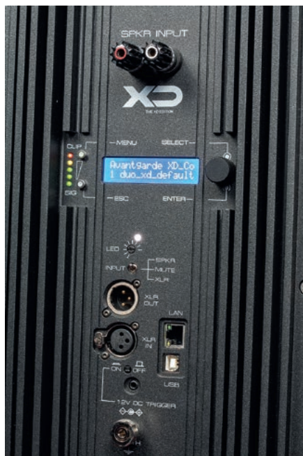
Nowy wzmacniacz i panel kontrolny wersji XD wygląda zupełnie inaczej; jest wyposażony w mały wyświetlacz, który pozwala przeprowadzić większość regulacji już w tym miejscu, bez zaprężania komputera; ten jednak da nam dostęp do jeszcze większych możliwości i pozwoli obserwować zmiany kształtu charakterystyki.
