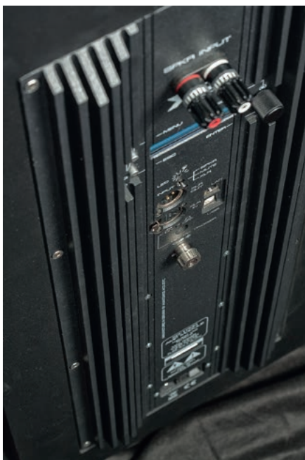
Dużą część tylnej ścianki obudowy sekcji niskotonowej zajmuje płyta wzmacniacza z wejściami, regulacjami i radiatorami – niezbędnymi nawet przy pracy w klasie D, skoro moc sięga aż 1000 W.
